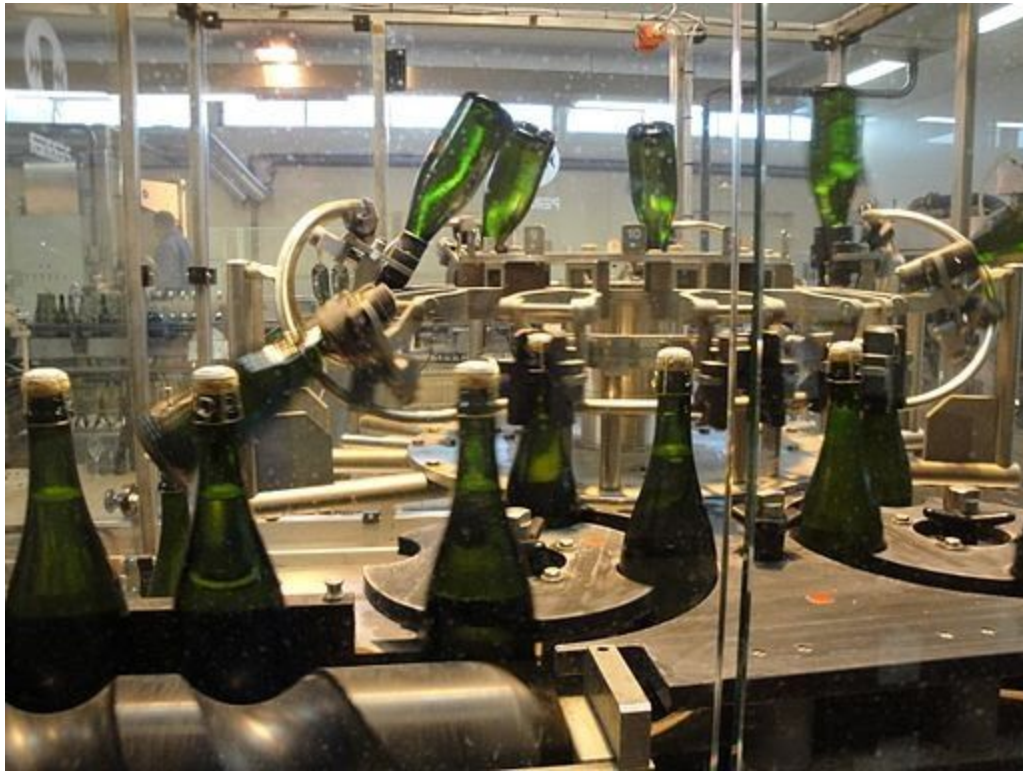
Maszyna do przeprowadzania disgorgement oraz korkowania butelek.
