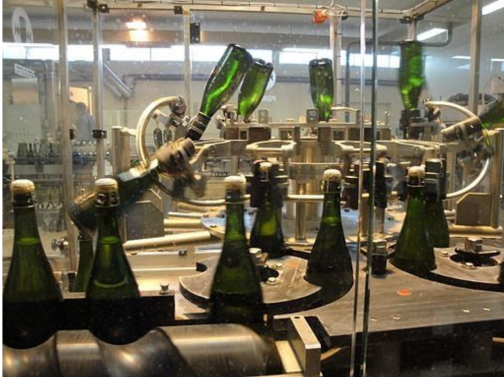
Maszyna do przeprowadzania disgorgement oraz korkowania butelek.
