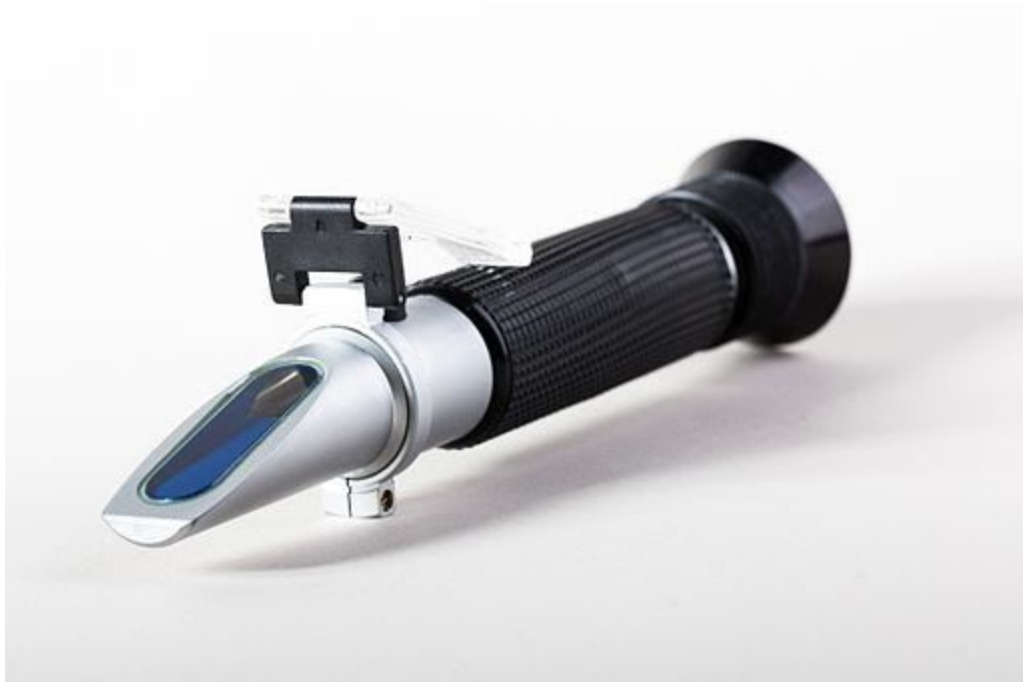
Przenośny refraktometr jakiego używają winiarze do badania dojrzałości gron. Photo by CEphoto, Uwe Aranas
